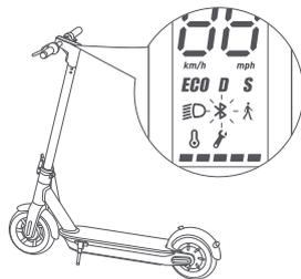
3 点击“车辆”→“搜索设备”，连接您的滑板车。滑板车发出蜂鸣，表示蓝牙连接成功。连接成功后，蓝牙图标保持常亮。
